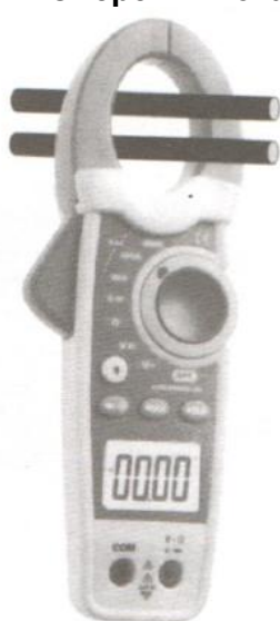
Неправильный способ измерения тока
