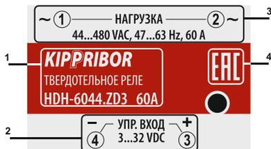
Рисунок 3 – таблички для серий HDH-●●44.ZD3[M01] / ZA2[M01]
